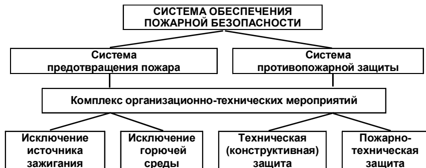
Рис. 1.1. Система обеспечения пожарной безопасности объекта защиты
