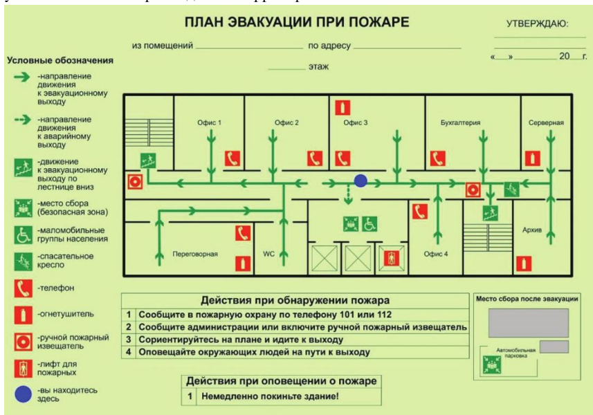
Рисунок 9 — Пример плана эвакуации
