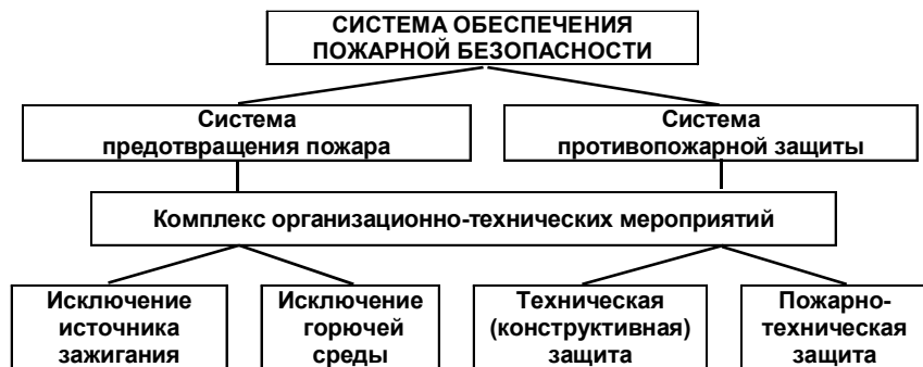
Рис. Система обеспечения пожарной безопасности объекта защиты
